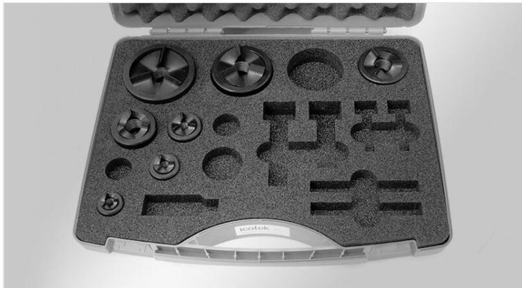
Les ensembles poinçons matrices ronds peuvent perforer des tôles d'acier ou d'aluminium et plastique jusqu'à 3mm d'épaisseur. Ces poinçons sont destinés à faire des ouvertures dans les tailles M16, M20, M25, M32, M40, M50, M63 qui correspondent à les presse-étoupes et systèmes passe-câbles d'icotek.
